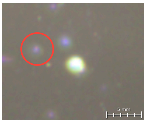
Abbildung 31: Darstellung eines Defekts auf der Rückseite. Umkreist ist ein Defekt mit Halo auf der Rückseite.
